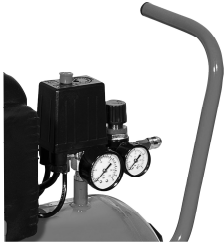
FIGURA 8 - DETALHE DO ENCAIXE DA MANGUEIRA COM O COMPRESSOR
