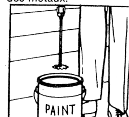
MALAXEUR DE PEINTURE: pour bien malaxer les peintures en bidons allant jusqu'à 1 gal.
