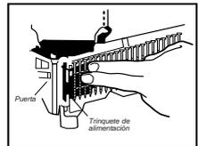
1) **Abra el cargador:** hale el pestillo de la puerta hacia abajo y gire y abra la puerta. Gire y abra la tapa del cargador.
