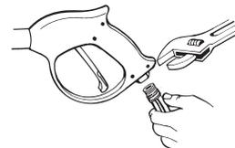
6. Branchez le boyau à haute pression à la sortie de l'appareil de lavage à haute pression et serrez fermement à la main.
