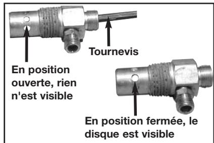
6. Appliquez un produit d'étanchéité sur les filets de la soupape. Réinstallez la soupape de retenue (en tournant dans le sens des aiguilles d'une montre).
