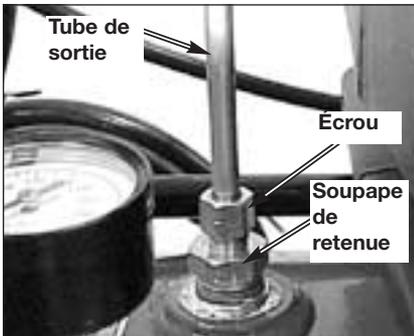
4. À l'aide d'une clé à douille, dévissez la soupape de retenue (en tournant dans le sens contraire des aiguilles d'une montre).
