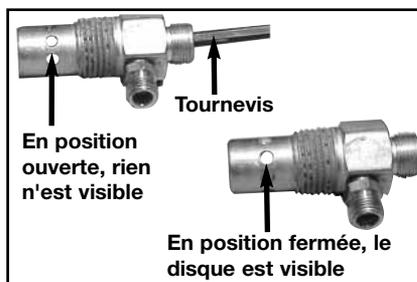
9. Nettoyez ou remplacez la soupape de retenue. Utilisez un solvant, tel qu'un décapant de peinture ou de vernis, pour nettoyer la soupape de retenue.
