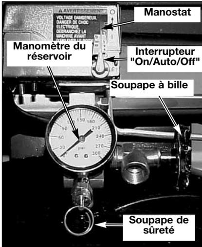
**Interrupteur marche/automatique/arrêt "On/Auto/Off"**: Placez cet interrupteur à la position "ON" pour alimenter le manostat et à la position "OFF" pour couper le courant après chaque utilisation.
