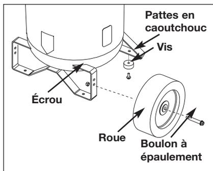
2. Serrez bien les pièces. **REMARQUE :** L'appareil sera à niveau si les roues sont posées de manière appropriée.
