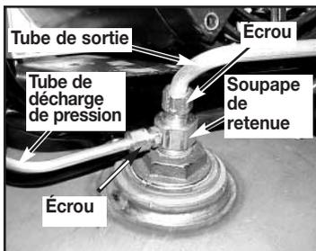
5. À l'aide d'une clé réglable, desserrez l'écrou du tube de décharge de pression au niveau du réservoir d'air et du manostat. Éloignez soigneusement le tube de décharge de pression de la soupape de retenue.
