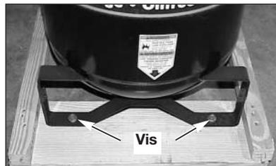
2. Retirez et jetez les quatre (4) vis fixant le compresseur d'air à la palette.
