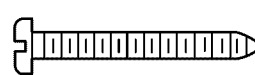
Tornillo para la consola de control de 6AB por 1-1/4 pulg. (instalación estándar)
