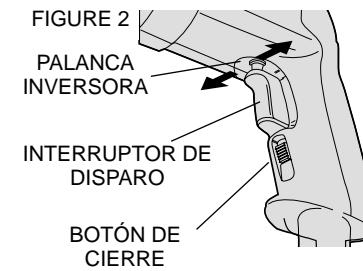
La palanca de inversión se utiliza para reversar el rotomartillo a fin de botar tornillos o brocas trabadas. Está ubicada encima del disparador, como se demuestra en la Figura 2. Para reversar el rotomartillo, apague (OFF) y empuje la palanca de inversión hacia la izquierda (visto desde el extremo del portabroca). Para posicionar la palanca en operación de avance, apague el rotomartillo (OFF) y empuje la palanca hacia la derecha.
