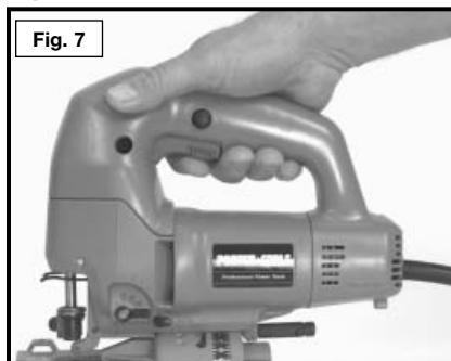
**TOME NOTA:** Se recomienda usar el ajuste orbital de "3" para el corte clavado.
