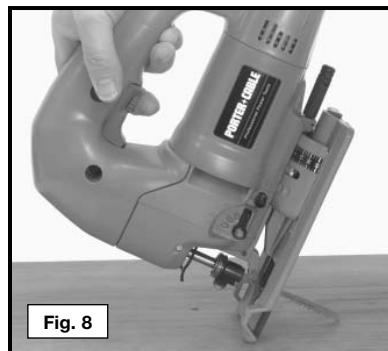
à l'intérieur de la marque. S'il faut un coin aigu, couper jusqu'au bord de la marque. Arrêter, reculer un peu, commencer à tourner et couper le long du côté. Faire de même à chaque coin pour retourner au point de départ. Retourner ensuite à chaque coin et couper dans la direction opposée. La semelle de la scie est assez large pour offrir une surface solide de guidage de chaque côté de la coupe.
