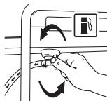
2. Mover el control de estrangulamiento (choke) ubicado en el motor a la posición de "CHOKE".
