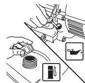
**⚠ PRECAUCIÓN** Mantenga el combustible fuera del alcance de los niños. Nunca llenar el tanque de combustible completamente. Sólo llenar el tanque hasta 13mm (1/2") por debajo de la parte inferior del cuello de la toma para permitir la expansión del combustible. Limpiar cualquier derrame de combustible del motor o del equipo antes de arrancar el motor. Limpie los derrames de combustible en el motor y el equipo y, antes de arrancar el motor, asegúrese de que el área esté seca.
