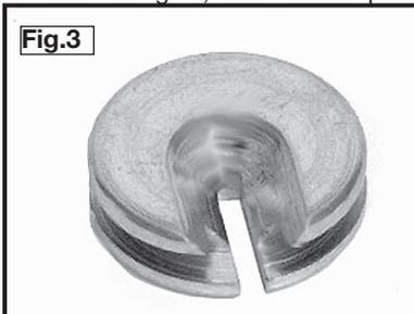
Pour poser l'insert, retirer la lame de scie de la scie à baïonnette et placer l'insert dans la gorge de la semelle de la scie avec la fente dirigée vers l'avant et le côté biseauté de la fente dirigé vers le haut. Poser la lame appropriée de la manière décrite dans la section POSE DE LA LAME avec le corps de la lame dans la fente de l'insert.
