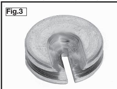
Para instalar el inserto, quite la segueta de la Sierra Caladora. Meta el inserto, con la ranura hacia adelante y los cantos biselados de la ranura hacia arriba, en la garganta de la base de la sierra. Instale una segueta apropiada según la sección PARA INSTALAR LA SEGUETA y con la segueta en la ranura del inserto.
