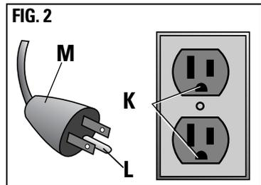
**▲ AVERTISSEMENT :** Risque de choc électrique. **UNE MISE À LA TERRE INADÉQUATE PEUT PROVOQUER UN CHOC ÉLECTRIQUE.**
