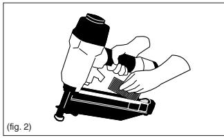
Appuyer sur le débrayage du pousseur pour désenclencher l'élévateur
